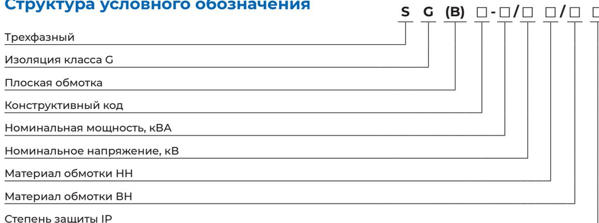
**Пример записи:** SGB10 2000/10 Cu/Cu IP31 – силовой сухой трансформатор серии SGB с воздушнобарьерной изоляцией класса H, на номинальное напряжение 10 кВ, мощностью 2000 кВА, материал обмоток высокого и низкого напряжения из меди, степень защиты IP31 в защитном
